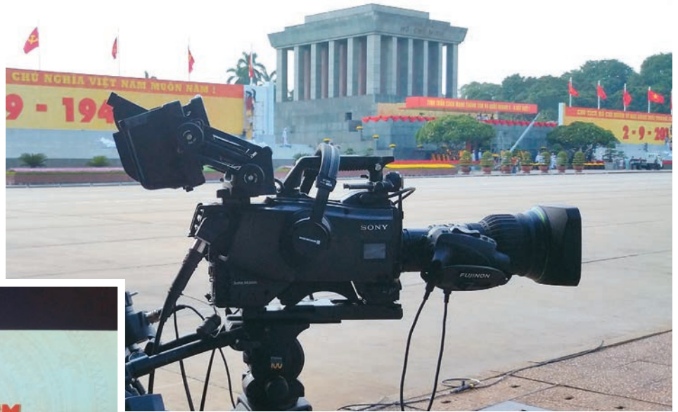
Máy quay Sony HDC-4300 được VTV sử dụng tại Lễ kỷ niệm 70 năm Quốc khánh 2-9.
